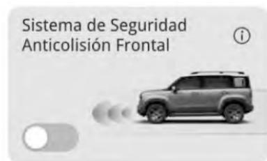
Después de arrancar el vehículo, FCS se predetermina en el estado ON (encendido). Puede encender o apagar esta función a través del interruptor "Configuración" → "Asistencia de conducción" → "FCS" en la pantalla táctil de IVI.
