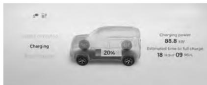
Muestra el ícono de "Cargando", porcentaje de batería actual, conexión de carga y el ícono de estado de carga.
