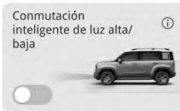
Después de arrancar el vehículo, el interruptor de luz alta/baja inteligente se apaga de forma predeterminada. Puede activar o desactivar el interruptor de luz alta/baja inteligente mediante "Configuración" → "Asistencia de conducción" → "Interruptor de luz alta/baja inteligente" en la pantalla táctil de IVI. El sistema recordará su elección, y el estado del interruptor de la luz alta/baja inteligente permanecerá sin cambio cuando se encienda de nuevo el vehículo.
