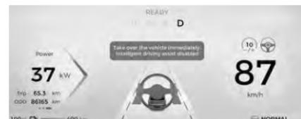
Durante el recordatorio de manos libres/control del conductor, cuando usted tome el control del vehículo, tal como girar el volante o presionar el pedal del acelerador, la función de IDA reanudará el control normal si presiona el pedal del freno, se saldrá la función de IDA y se entregará el vehículo a usted para su control.
