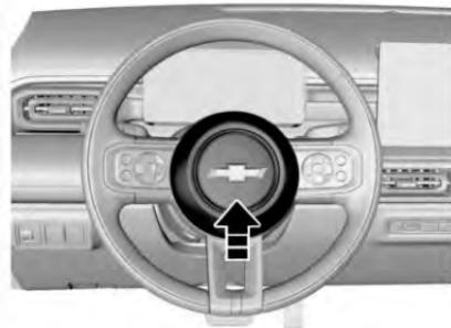
Presione la parte central del volante para sonar el claxon.
