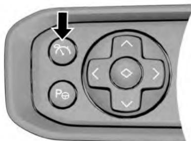
Cuando el vehículo esté en velocidad D, presione brevemente el botón On/Off (encendido/apagado) en el volante para activar la función de ACC.
