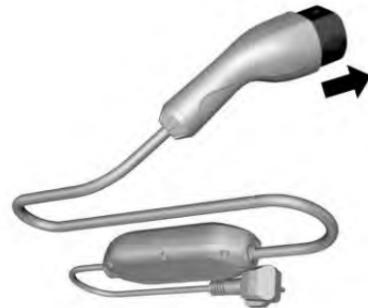
5. Retire el tapón de la pistola de carga, luego inserte el enchufe en el puerto de carga del vehículo.
