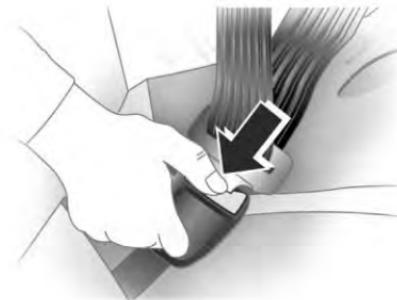
Si necesita liberar el cinturón de seguridad, presione el botón rojo en la hebilla, y la lengüeta saldrá automáticamente y el cinturón de seguridad se retraerá automáticamente. El cinturón de seguridad está bloqueado debido a que se retrae o se extrae demasiado rápido, y puede extraerse suavemente aflojando el tejido.
