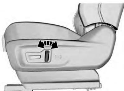
Como se muestra en la figura, gire el interruptor de ajuste hacia adelante y hacia atrás, y el respaldo se doblará hacia adelante o se desdoblará hacia atrás. Suelte el interruptor cuando esté ajustado a una posición adecuada.
