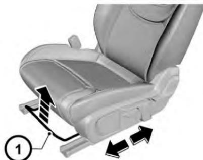
Jale hacia arriba la varilla de ajuste ① en la parte inferior delantera del asiento para ajustar el asiento hacia adelante o hacia atrás, y suelte la varilla después de que el asiento esté ajustado a la posición adecuada.
