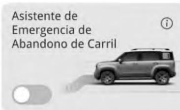
Después de arrancar el vehículo, ELK se predetermina en el estado ON (encendido). Puede encender o apagar esta función a través del interruptor "Configuración" → "Asistencia de conducción" → "ELK" en la pantalla táctil de IVI. Después de apagar el vehículo, el sistema no memorizará su selección. Una vez
