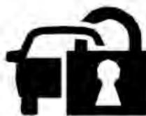
Este indicador se ilumina cuando se abre la puerta. Se apagará después que el vehículo entre al estado READY. Esto indica que el indicador puede funcionar normalmente.
