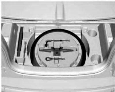
La llanta de refacción, el gato y las herramientas están debajo del compartimiento de equipaje y se pueden ver después de levantar el piso del compartimiento de equipaje. Las herramientas del vehículo incluyen un estribo de gato, una llave de casquillo, destornillador.
