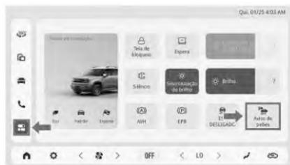
Como se muestra en la figura anterior, toque el ícono de [Centro de control] en la barra de navegación izquierda en la pantalla de la consola central IVI para ajustar a través de [Alerta de peatón].
