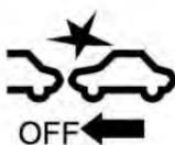
Cuando este indicador se ilumina, significa que "FCS" o "ESC" está desactivado y la conducción normal no es afectada. Puede activar las funciones por medio de los interruptores "FCS" y "ESC" en la pantalla táctil de la IVI.
