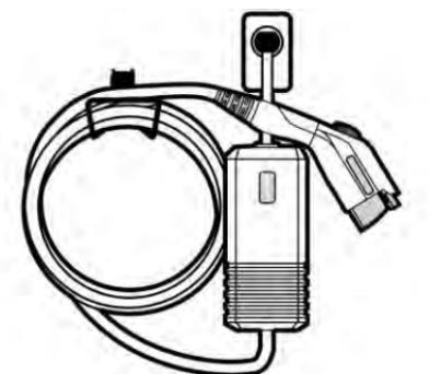
2. Monte el cable de carga para reducir la tensión en el tomacorriente/enchufe. Monte la caja de control en un lugar adecuado para evitar el estrés físico en los tomacorrientes y los componentes del cable de carga.
