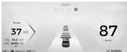
Después de que se active la asistencia de conducción inteligente, el instrumento mostrará las líneas de carril y los íconos del volante en azul. El sistema ayudará a controlar el volante y la velocidad del vehículo. El tablero
