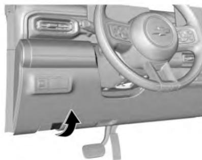
1. Como se muestra en la figura, jale la manija de liberación de la cubierta del puerto de carga (cerciórese de que el cofre esté completamente cerrado), y la cubierta del puerto de carga se abrirá automáticamente.
