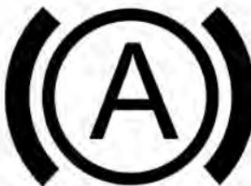
Después de encender el vehículo, el indicador de funcionamiento de AVH se ilumina por unos cuantos segundos y después se apaga. Esto indica que el indicador puede funcionar normalmente.
