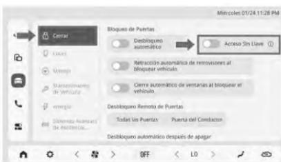
El interruptor de desbloqueo pasivo se puede encender o apagar por medio de IVI - Configuración del vehículo - Puertas y Ventanas - Seguros de ventana y puerta - Desbloqueo pasivo.
