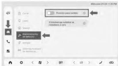
El interruptor de servicio del limpiador se puede encender o apagar en [Configuración del vehículo-Mantenimiento del vehículo] del tablero de control central IVI
