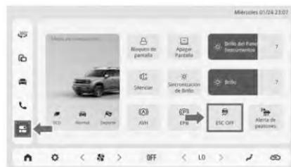
Como se muestra en la figura anterior, oprima el ícono de [Centro de control] en la barra de navegación izquierda de la pantalla de control central del vehículo para ajustar a través del [ESC].
