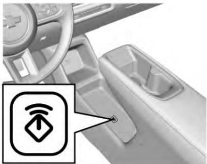
Coloque el lado de la llave inteligente con el logotipo de Chevrolet cerca de la posición de almacenamiento en la consola (como se muestra en la figura anterior). Pise el pedal del freno para poner el vehículo en estado de READY.
