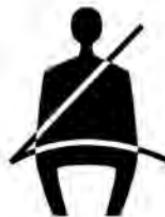
Cuando el vehículo se enciende y el conductor no se abrocha el cinturón de seguridad, se encenderá la luz de advertencia del cinturón de seguridad. Las siguientes circunstancias aparecerán a menos que el conductor se abroche el cinturón de seguridad adecuadamente:
