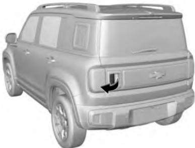
Cuando las puertas están bloqueadas y el vehículo está apagado, lleve una llave legal a un área determinada (dentro de unos 1.2 m) de la puerta trasera, y presione el interruptor de liberación de la puerta trasera para certificar el sistema y la llave. Después de una autenticación exitosa, la puerta trasera se desbloquea.
