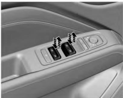
El interruptor de elevación del cristal se ubica en el tablero del descansabrazos de la puerta delantera. Los interruptores izquierdo y derecho controlan el cristal de la ventana izquierda y derecha, respectivamente.
