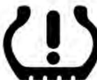
Cuando la presión de las llantas es baja, este indicador permanece encendido cuando el sistema TPMS falla, este indicador parpadea durante un periodo de tiempo y después permanece encendido. (En caso de un TPMS directo, cuando la presión de las llantas es demasiado alta, el indicador también estará encendido normalmente.) Por favor revise y ajuste oportunamente la presión de aire.
