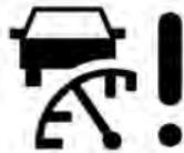
Si este indicador de advertencia se ilumina, indica que hay una falla en ACC. Sin embargo, no afecta la conducción manual normal. Por favor vaya a una estación de servicio autorizada para reparación.
