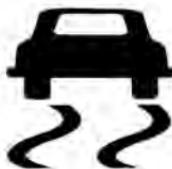
Después de encender el vehículo, el indicador se iluminará brevemente y después se apagará, lo que significa que el indicador funciona normalmente. Durante la conducción, si se activa el ESC, la luz ESC parpadeará para notificar al conductor que el sistema está
