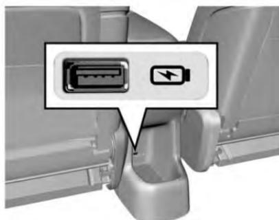
La interfaz USB se encuentra detrás del tablero de instrumentos de la consola y proporciona energía de carga para los pasajeros traseros.
