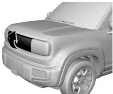
2. Como se muestra en la figura, abra la cubierta del puerto de carga haciendo que emerja hacia arriba.
