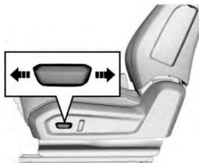
Como se muestra en la figura, el interruptor de ajuste eléctrico está en el lado exterior del asiento. Presione el interruptor hacia adelante o hacia atrás, y el asiento se moverá hacia adelante o hacia atrás según corresponda. Libere el interruptor cuando alcance una posición adecuada.
