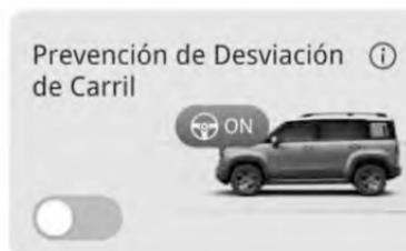
Después de arrancar el vehículo. Puede encender o apagar esta función a través del interruptor "Configuración" → "Asistencia de conducción" → "LDP" en la pantalla táctil de IVI.
