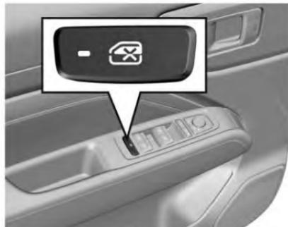
El interruptor de desbloqueo/bloqueo con un botón se localiza en el tablero del descansabrazos de la puerta delantera. Cuando se presiona el botón, la luz indicadora se enciende y las ventanas sólo se pueden operar desde el tablero de control de la ventana en la posición del conductor.
