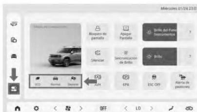
Como se muestra en la figura anterior, toque el icono de [Centro de control] en la barra de navegación izquierda en la pantalla de la consola central IVI para cambiar a través del [Modo de conducción].
