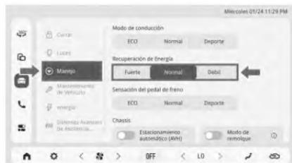
Como se muestra en la figura anterior, toque el ícono [Configuración del vehículo] en la barra de navegación izquierda en la pantalla de la consola central IVI. Seleccione [Conducción-Modo de recuperación de energía] para realizar los ajustes.
