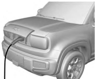
Inserte la pistola de carga en el puerto de carga.
