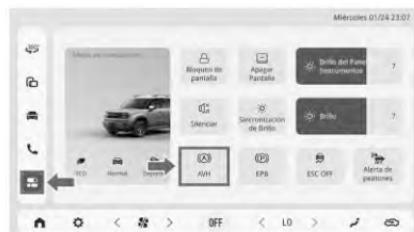
El interruptor de acceso directo está puesto en el [Centro de control-Estacionamiento automático] en la barra de navegación izquierda de la pantalla IVI de la consola central.
