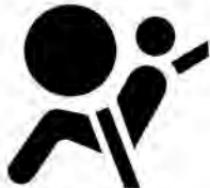
En el tablero de instrumentos, hay un indicador de bolsa de aire que muestra un símbolo en forma de una bolsa de aire. El sistema verificará si el sistema del circuito de la bolsa de aire tiene una falla y dará el aviso correspondiente a través del indicador. El indicador se iluminará en caso de falla del sistema de bolsa de aire. Se debe revisar y reparar lo antes posible. Consulte la sección "Dispositivo de instrumentos y control" para obtener información detallada.
