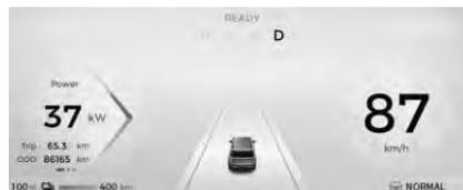
Como se indica en la figura anterior: En el instrumento, la línea lateral del carril donde se desvía el vehículo se muestra como advertencia de color naranja, indicando que existe peligro de desvío del carril.
