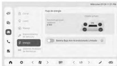
Toque el botón "Batería baja - Restricción de uso de A/C" para activar/desactivar esta función.
