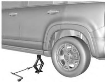
5. Gire el estribo del gato en sentido de las manecillas del reloj para permitir que el gato suba lentamente y asegúrese que la cabeza del gato esté firmemente presionada en la posición de elevación.
