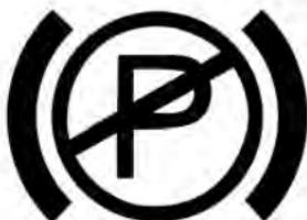
Después que el vehículo se encienda, la luz de advertencia de falla del EPB se ilumina durante varios segundos y después se apaga, indicando que la luz de advertencia y el módulo de función EPB funcionan normalmente.
