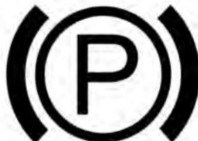
El indicador de funcionamiento del freno electrónico de estacionamiento (EPB) se ilumina cuando se jala el freno electrónico de estacionamiento. Esto indica que el vehículo está en estado de estacionamiento.
