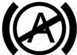
Después que el vehículo se encienda, si la luz de advertencia de falla de AVH se ilumina durante varios segundos y después se apaga, esto indica que la luz de advertencia y el módulo de función AVH funcionan normalmente.
