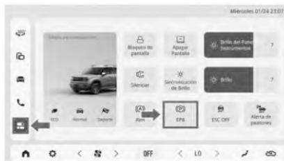
El interruptor de acceso directo está puesto en el [Centro de control-EPB] en la barra de navegación izquierda de la pantalla de control central del vehículo.
