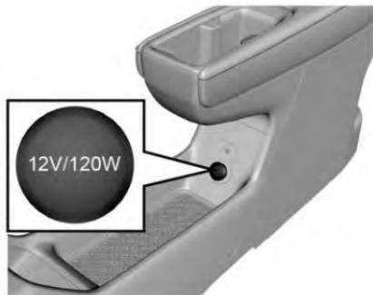
Como se muestra en la figura anterior, el enchufe de suministro de corriente de 12V se encuentra debajo del portavasos trasero de la consola. El enchufe se puede usar para alimentar aparatos eléctricos de 12V, con una corriente de carga máxima de 10A y una carga de potencia de 120W.
