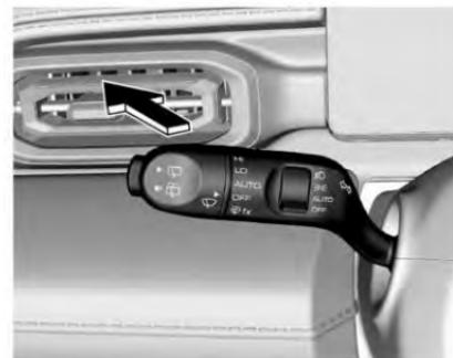
Como se muestra en la figura, empuje la palanca de control hacia el tablero de instrumentos para activar la luz alta. Para regresar a la luz baja, empuje la palanca de control hacia el tablero de instrumentos de nuevo.
