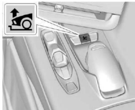
Para usar el Sistema de elevación delantera, presione el botón en la consola central para levantar o bajar el vehículo. Esta función se puede operar en velocidades hasta de 38 km/h
