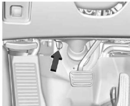
1. Localice el lazo del cable de liberación manual a la izquierda del pedal del freno.
