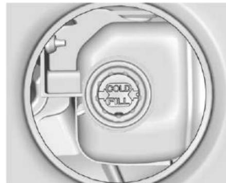
Cuando el motor está frío, el nivel del refrigerante debe estar en el indicador COLD FILL (llenado en frío) del tanque de compensación del refrigerante.
