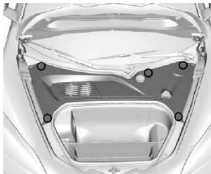
2. Libere los cinco sujetadores y retire la cubierta exterior.
