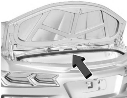
Use la copa para jalar para bajar la puerta trasera si se necesita, y después deje caer dentro del seguro o empuje sobre el exterior del tablero hasta que se active la función de cierre eléctrico. La puerta trasera/cajuela se cerrará el resto de su trayectoria y el cerrojo se colocará automáticamente.
