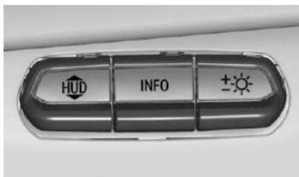
El control del HUD está al lado izquierdo del volante en el tablero de instrumentos.
