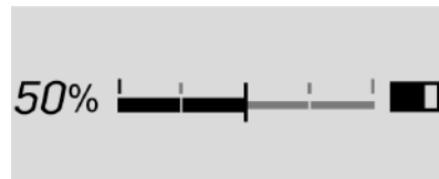
Esto muestra el estado de carga de la batería de alto voltaje y se muestra en el modo Transporte y Silencioso. El valor de la izquierda es una estimación del estado de carga restante de la batería de alto voltaje.
