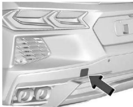
Abra la cubierta usando la pequeña muesca que sella el receptáculo trasero para cáncamo de remolque.
