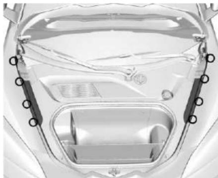
1. Libere los cuatro sujetadores para las cubiertas exteriores izquierda y derecha.
