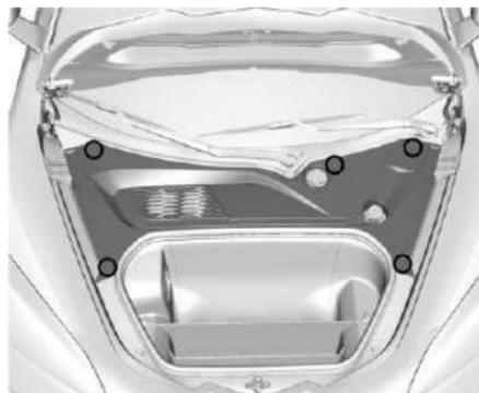
6. Libere los cinco sujetadores y retire la cubierta exterior para tener acceso a la batería.
