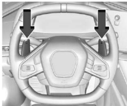
Con la transmisión en D (conducción), presione el interruptor M (Modo manual) en la consola central para entrar al Modo manual. Use las paletas en el volante para hacer un cambio ascendente o descendente a la transmisión. La paleta derecha + (más) hace cambios ascendentes, y la paleta izquierda - (menos) hace cambios descendentes.
