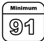
Se requiere gasolina sin plomo Premium que cumpla la especificación D4814 de ASTM con una clasificación de octanaje publicada (R+M)/2 de 91 o mayor. El uso del combustible correcto es una parte importante del mantenimiento adecuado del vehículo y una condición de la garantía del vehículo. Si se escucha un golpeteo fuerte al utilizar gasolina de 91 octanos o mayor, el motor necesita servicio.
