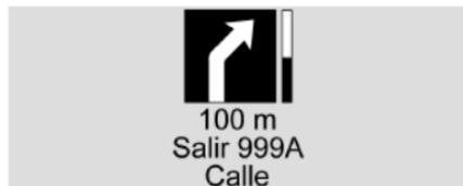
**Navegación:** Si está equipado, muestra la información de la navegación paso a paso cuando la navegación está activa y hay una maniobra pendiente próxima. Aparece hasta que se complete la maniobra, y después la imagen de HUD regresa a la vista previa.
