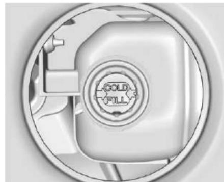
4. Llene el tanque de compensación del refrigerante con la mezcla adecuada hasta que el nivel del interior del tanque se establezca en el indicador COLD FILL (llenado en frío) que se encuentra en el frente del tanque de compensación.
