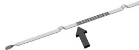
Si el aceite está por debajo del área de líneas cruzadas de la punta de la varilla de medición, añada por lo menos 1 L (1 qt) del aceite recomendado a través de la abertura del tapón de llenado del aceite en el tubo de relleno del tanque de aceite y revise el nivel otra vez. Consulte "Selección del aceite correcto para el motor" más adelante en esta sección respecto al tipo de aceite a usar. Para conocer la capacidad del cárter de aceite, consulte *Capacidades/especificaciones* ⇨ 381.
