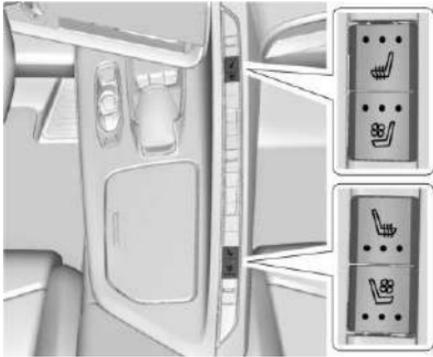
Si está equipado, los botones están cerca de los controles del clima en la consola. Para que funcione, el motor debe estar encendido.
