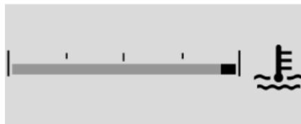
Este indicador muestra la temperatura del refrigerante del motor.
