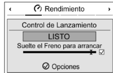
7. Presione completamente el acelerador. Suelte el pedal del freno para arrancar el vehículo.
