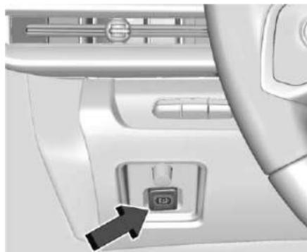
El Freno de estacionamiento eléctrico (EPB) siempre puede aplicarse, incluso con el vehículo apagado. En caso de falta de energía eléctrica, el EPB no puede activarse ni liberarse. Para evitar que se agote la batería, evite ciclos repetidos innecesarios del EPB.
