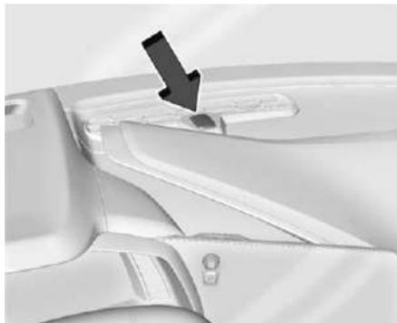
Si está equipado, la luz indicadora, en el tablero de instrumentos, cerca del parabrisas, indica la condición del sistema.
