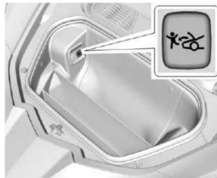
El compartimiento debajo del cofre está equipado con un botón de liberación de cofre de emergencia que brilla en la oscuridad. Este botón brilla después de ser expuesto a la luz. Presione el botón para abrir el cofre desde el interior del compartimiento del cofre.
