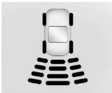
El cuadro de instrumentos puede tener una pantalla de Asistente de estacionamiento con barras que muestren "distancia hasta el objeto" y la información de la ubicación del objeto para RPA. Al acercarse el objeto, más barras se encienden y las barras cambian de color de amarillo a ámbar y a rojo.
