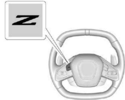
Para activar el Modo Z, presione el botón Modo Z en el volante. Para desactivar, seleccione un modo diferente a través de la perilla DMC, o presione el botón de Modo Z en el volante.
