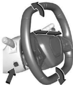
Presione el control para mover la inclinación y el ajuste telescópico del volante hacia arriba y hacia abajo o hacia adelante y hacia atrás.
