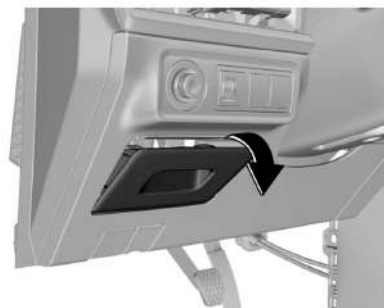
Caja de fusibles interior
